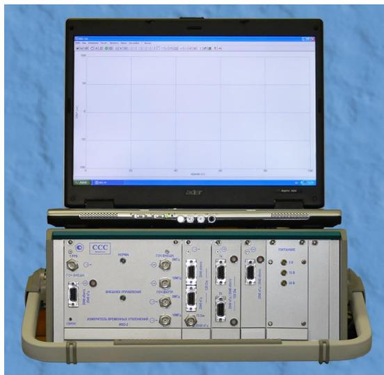
Прибор ИВО-2 обеспечивает измерение параметров блуждания фазы (Wander) одного или двух синхросигналов 2,048 МГц и/или 2,048 МБит/с одновременно, а именно:
